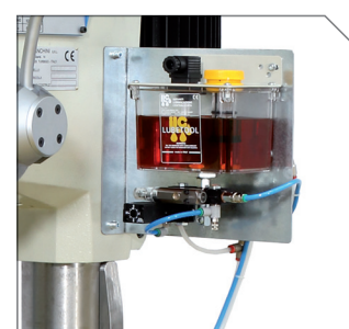
LUBRIFICAZIONE AUTOMATICA PUNTE AUTOMATIC DRILLING BIT LUBRICATION
